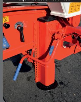
Béquilles stabilisatrices à commande manuelle ou pneumatique individuelle qui assure la stabilité au déchargement.
