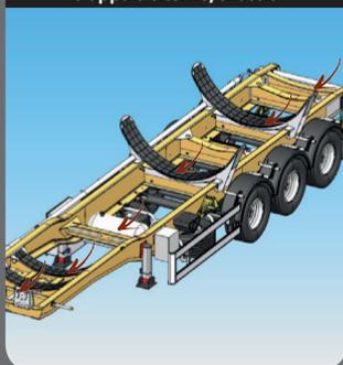
6 appuis disposés à l'avant (x2) au centre (x2) puis à l'arrière du châssis (x2) qui assurent une stabilité parfaite !
