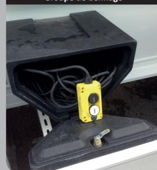
Groupe de bennage à commande filaire fournis avec un câble de 20 mètres.
