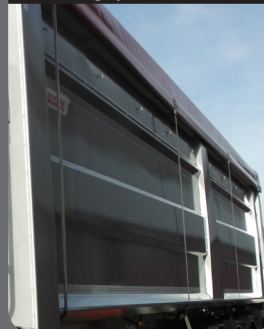
Assemblage par soudures laser
