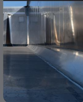
Limite la rétention de produit au bennage et favorise l'écoulement.
