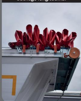
Bâchage longitudinal par câble à commande manuelle ou électrique.
