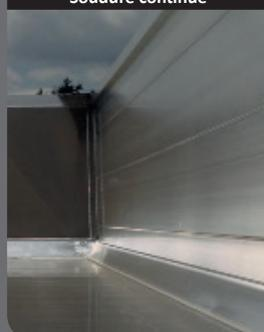
Procédé de soudage en continue qui garantit une parfaite étanchéité au niveau des assemblages.
